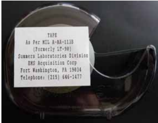
Bild 1: verwendetes Klebeband für den Test adhesion
