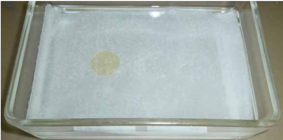
Bild 6: Testaufbau salt solution
